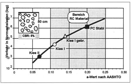
Abb. 5: Tragfähigkeitswerte und mögliche Verkehrsbelastung.
