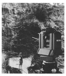
Fig. 2: Pendant que la réfection de la paroi rocheuse s'effectue dans des conditions dangereuses, le théodolite motorisé Wild TM3000 du système Leica APSWin, installé à bonne distance, réalise en mode automatique des mesures de haute précision sur des points situés à gauche et à droite de la zone de glissement. Jusqu'ici aucun autre mouvement n'a été enregistré sur le versant.
