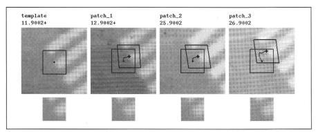
Abb. 5: Image Matching von vier natürlichen Verknüpfungspunkten (30  $\mu$ m Bilddaten).
