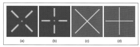
Abb. 1: Templates für die Rahmenmarken (a, b) und die signalisierten Punkte (c, d).
