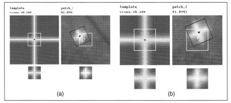
Abb. 4: Template Matching der signalisierten Punkte in 30  $\mu\text{m}$  (a) und 15  $\mu\text{m}$  (b) Bilddaten.
