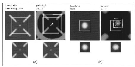
Abb. 2: Template Matching der Rahmenmarken in 30  $\mu\text{m}$  (a) und 15  $\mu\text{m}$  (b) Bilddaten
