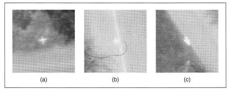
Abb. 3: Beispiele für eine gute (a), schlechte (b) und zerstörte Signalisierung (c).
