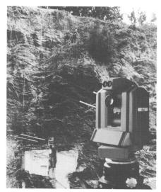
Abb. 2: Während die «Felsputzer» im gefährdeten Hang über der Kantonsstrasse ihrer gefährlichen Arbeit nachgehen, überwacht der motorisierte Präzisionstheodolit Wild TM3000 als Teil des Leica Systems APSWin aus sicherer Distanz automatisch zahlreiche Punkte links und rechts des Abbruchgebietes. Bis jetzt haben sich keine anderen Teile des Hanges mehr bewegt.
