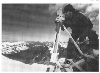
Abb. 2: Die Orte der Probenentnahme des Gletschereises am Mt. Blanc wurden auf der Basis vorliegender Radarmessungen mit dem elektronischen Laservermessungsgerät Wild TC1610 bestimmt und dokumentiert. Der Glaziologe Louis Reynaud (Blld) kann aus solchen Vermessungsdaten in 4300 m ü.M. die Volumenveränderungen und Fliessgeschwindigkeiten des Gletschereises ermitteln.
