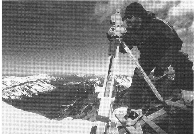
Abb. 2: Die Orte der Probenentnahme des Gletschereises am Mt. Blanc wurden auf der Basis vorliegender Radarmessungen mit dem elektronischen Laservermessungsgerät Wild TC1610 bestimmt und dokumentiert. Der Glaziologe Louis Reynaud (Bild) kann aus solchen Vermessungsdaten in 4300 m ü.M. die Volumenveränderungen und Fließgeschwindigkeiten des Gletschereises ermitteln.
