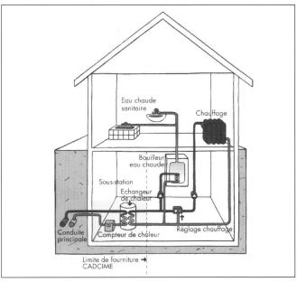
Abb. 2: CADCIME: Prinzipschema der Wärmeverteilung in den Gebäuden (Schema: CADCIME).
