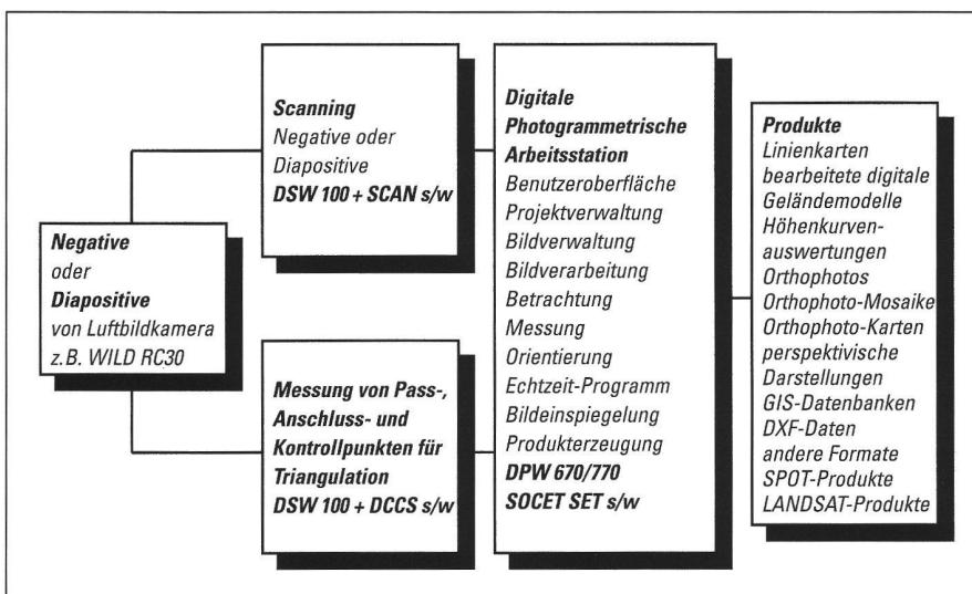
bildkamera, wie z.B. Leicas WILD RC30, beginnen. Diese Bilder müssen zunächst digitalisiert, d.h. mit Hilfe eines Scanners eingelesen werden. Dies wird erreicht mit der DSW 100 «Digital Scanning Workstation» und dem Softwaremodul SCAN.
