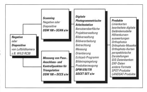
bildkamera, wie z.B. Leicas WILD RC30, beginnen. Diese Bilder müssen zunächst digitalisiert, d.h. mit Hilfe eines Scanners eingelesen werden. Dies wird erreicht mit der DSW 100 «Digital Scanning Workstation» und dem Softwaremodul SCAN.
