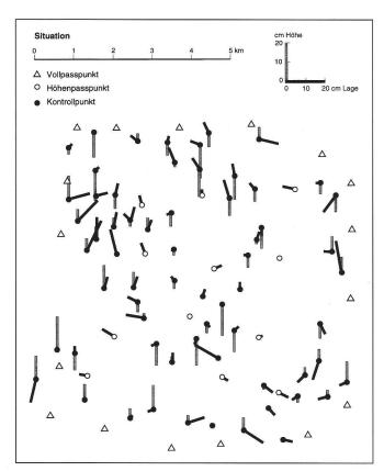
Abb. 11: Klaffungen in Lage und Höhe der verbleibenden Kontrollpunkte (Version P1: ohne GPS – mit 29 Passpunkte).
