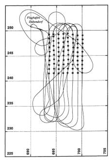
Abb. 3: GPS-Trajektorie mit Projektionszentren beider Flüge in Landeskoordinaten (Einheiten in km).
