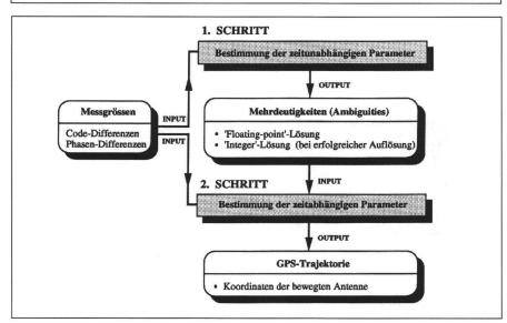
Abb. 5: Auswerteschema für kinematische GPS-Daten.
