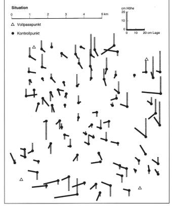
Abb. 12: Klaffungen in Lage und Höhe der verbleibenden Kontrollpunkte (Version P3: mit GPS (O1) – mit 4 Passpunkte).
