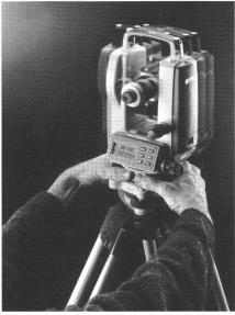
Théodolite électronique de chantier Leica T100.
