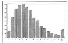
Abb. 4: Restfehler der Passpunkte bei globaler Transformation, Kartonpläne 1:500.
