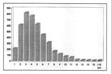
Abb. 3: Restfehler der Passpunkte bei globaler Transformation, Alupläne 1-500
