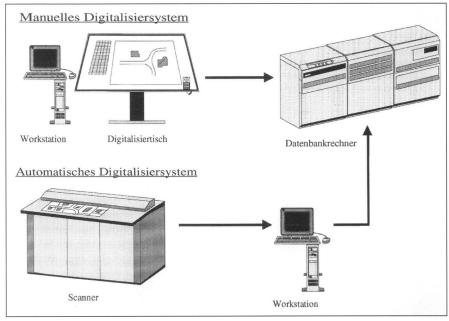
Abb. 1: Geodätisches Digitalisiersystem.
