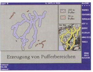
Abb. 2: Räumliche Analysen durch Pufferung von Gewässern und Verschneidung mit anderen Datenbasen.
