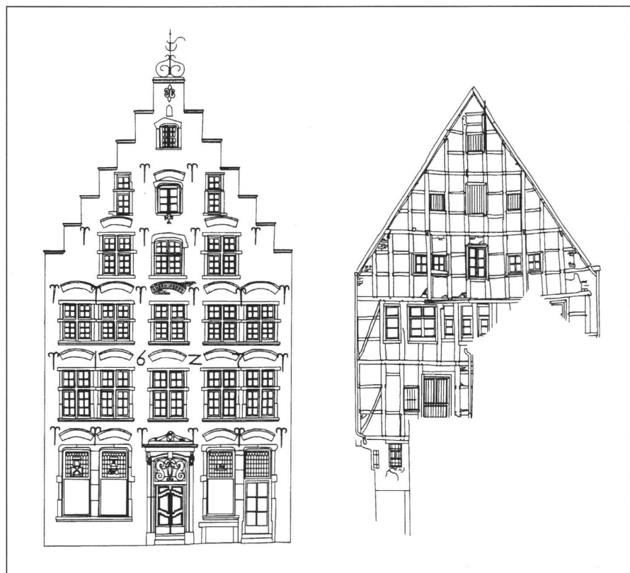
Abb. 1: Verformungstreu Vorder- und Rückansicht «Haus Kurfürst»; erstellt mit dem Vermessungssystem MOBI.
