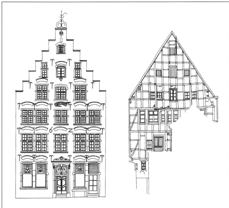
Abb. 1: Verformungstreue Vorder- und Rückansicht «Haus Kurfürst»; erstellt mit dem Vermessungssystem MOBI.
