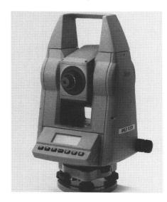
Le nouveau tachéomètre WILD TC500 de Leica AG se caractérise par une précision de mesure optimale, un grand confort d'emploi et une excellente robustesse. Du point de vue de ses fonctionnalités et de la précision de ses mesures d'angles et de distance, il est conçu pour tous les types de levés intervenant sur un chantier de même que pour les applications cadastrales et les mesures d'incénierie
