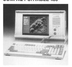
Die blitzschnellen Rechner der Familie COM-PAQ PORTABLE 486 werden ab sofort standardmässig mit dem Prozessor Intel 486DX2 mit 66 MHz Taktfrequenz ausgeliefert. Sie sind damit die leistungsstärksten Portables der Welt, bieten sie doch beispielsweise bis zu 75% mehr Rechenleistung.
