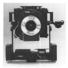
Die Photogrammetrie-Kamera Rollei LFC-Metric mit dem Bildformat 23 × 23 cm wird mit Genauigkeitsanforderungen von 1/100 000 der Objektausdehnung beispielsweise für berührungslose Messungen im Fahrzeug- und Flugzeugbau eingesetzt (Foto: Rollei).
