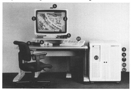
Intergraph bietet jetzt mit «InterMap Digital» (IMD) eine neue digitale Photogrammetrie-Workstation. Sie basiert auf der ImageStation 6487 und ist ebenfalls mit dem Intergraph-RISC-Prozessor Clipper-C400 sowie einem zusätzlichen Parallelprozessor, VI-50 von VITec, ausgestattet. Die integrierte Doppelarchitektur erlaubt die gleichzeitige Verarbeitung und Darstellung von Vektor- und Rasterdaten und bietet somit Höchstleistungen auf dem Gebiet der Bildverarbeitung.
