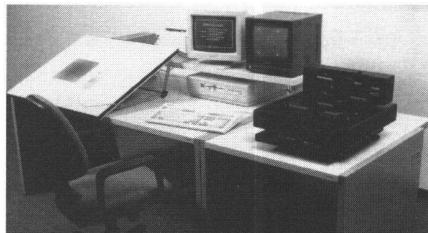
Der moderne Arbeitsplatz der Photogrammetrie-Auswertung ist mit einem Durchleucht-Digitizer, einem Réseausranscaner mit Monitor sowie einer Rechnereinheit mit Steuerungs- und Berechnungssoftware ausgestattet (Foto: Rollei).
