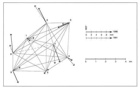
Fig. 3: Vecteurs-résidus des coordonnées des compensations des distances observées en 1986 et 1991 par la méthode des facteurs d'échelle locaux, par rapport aux coordonnées issues de la compensation de référence du réseau terrestre complet. Les coordonnées de référence marquent l'origine des vecteurs-résidus.
