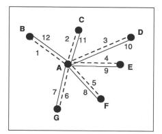
Fig. 1: Schéma d'observation des distances par la méthode des paramètres d'échelle locaux. Depuis A, on observe d'abord les distances 1 à 6 dans le sens des aiguilles d'une montre, puis les observations 7 à 12 dans le sens contraire. En outre, on ne mesure que la température en A.
