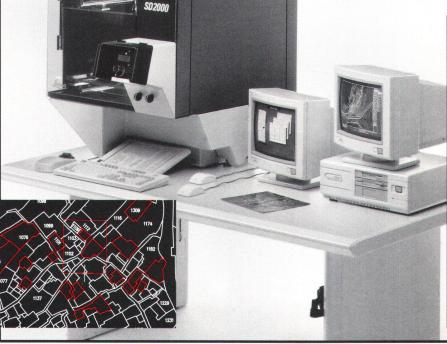
Eine universelle Arbeitsstation für jede photogrammetrische Aufgabe? SD 2000 mit AutoCAD
