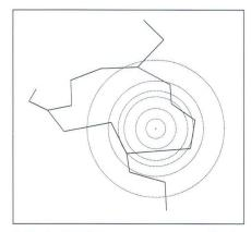
Abb. 1: Per Programm erzeugte Suchkreise mit Ankerpunkt als Zentrum, die für eine programmgesteuerte Identifikation entsprechender Liniensegmente der Einzelfläche dienen.
