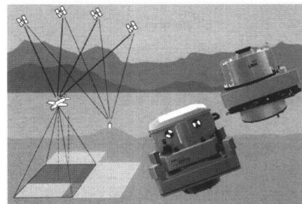
Das Bildflug-Management-System T-FLIGHT von Carl Zeiss ist konzipiert für die rechnergestützte Bildflugplanung, die GPS-gestützte Bildflugnavigation und die Dokumentation des durchgeföhrten Bildfluges. T-FLIGHT erhöht in entscheidendem Masse die Effizienz und Produktivität des Bildfluges durch:
