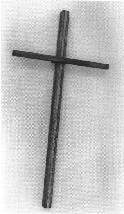
Abb. 6: Der Jakobsstab (Arbeitsgruppe: Ch. Marti, P. Scherrer, K. Zimmermann).
