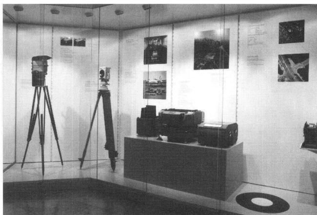
Abb. 2: Photogrammetrische Aufnahmemesskammern und Bodensignalisierung.
