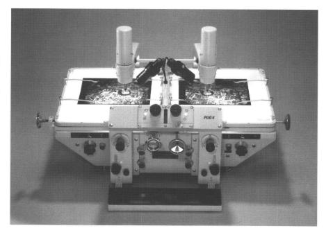
Darüber hinaus können Vergrösserungen individuell der Qualität des Bildmaterials oder der Arbeitsweise des Operateurs angepasst werden. Der effektive Punktdurchmesser in der Bildebene ändert sich umgekehrt proportional mit der Vergrösserung. Dadurch erscheint die Messmarke relativ zum Bild, auch bei unterschiedlicher Betrachtungsvergrösserung, in beiden Okularen gleich gross.
