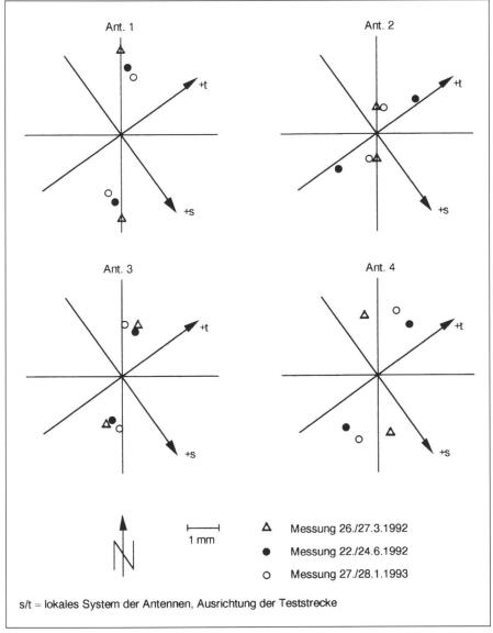
Abb. 4: Antennenoffsets der vier getesteten GPS-Antennen.
