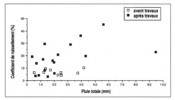
Fig. 3a: Variations des coefficients de ruissellement en fonction de la pluie totale pour les états avant et après travaux du Riau à Gollion.
