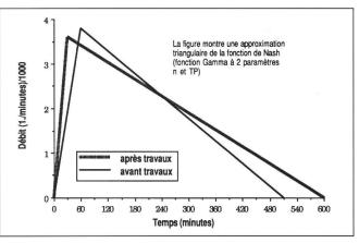
Fig. 5: Modifications de la fonction de transfert à la suite des travaux AF du Riau à Gollion.
