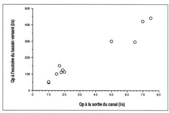
Fig. 8: Relation entre les débits mesurés à l'exutoire du canal et ceux enregistrés à l'exutoire du bassin versant du Riau à Gollion
