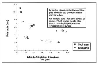
Fig. 4: Variations du seuil de ruissellement entre les états avant et après travaux du Riau à Gollion.
