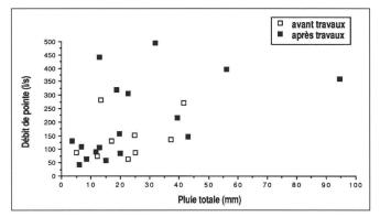
Fig. 3b: Variations des débits de pointe en fonction de la pluie totale pour les états avant et après travaux du Riau à Gollion.
