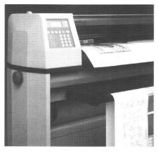
als einzige Vektorplotter im Markt über «Fuzzi Logic» zur Stift- und Vektoroptimierung. Fuzzi Logic erlaubt dem integrierten Computer die Zeichnungsdaten schneller und effizienter zu optimieren. Die XP-520 Plotter optimieren dank der «Look Ahead» Funktion die Daten zwischen 21 und 41 Vektoren über die gegenwärtige Stiftposition. Dabei wird laufend der Faktor gewählt, der ein Maximum an Durchsatzsteigerung garantiert
