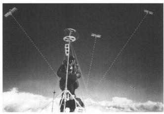
Abb. 2: Auf dem Mt. Everest-Gipfel hat Benoit Chamoux das Wild GPS System 200 eingeschaltet. Seine Antenne (rechts unten) empfängt die Signale der Navstar GPS Satelliten.
