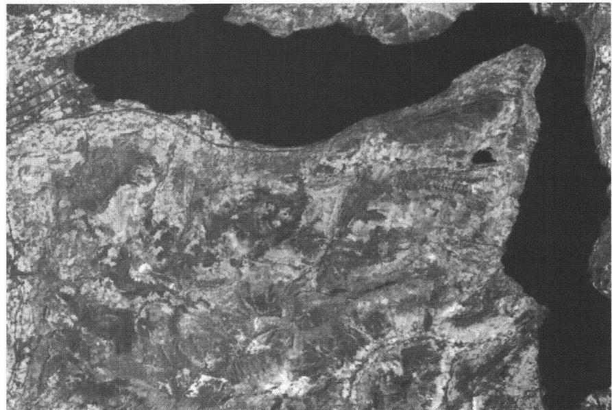
Abb. 2: Landsat TM Band 4, nach der Korrektur der Illuminationsunterschiede.
