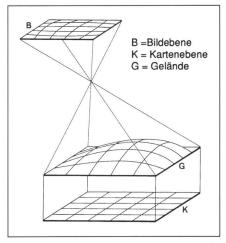
Abb. 1: Projektive Abbildung eines Gitternetzes.
