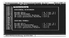
Abb. 3: Über das Fenster mit den Verbesserungen wurde mit F3 das Fenster mit den Genauigkeiten eingeblendet. Für die Berechnung der Horizontalwinkel-Genauigkeit wurden nur 4 von 5 möglichen Sätzen verwendet. (Satz 4 ist desaktiviert.)
