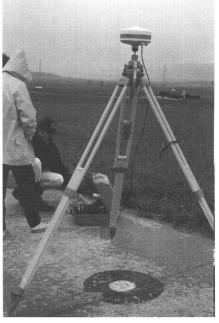
Fig. 3: Stationnement GPS sur l'un des repères. La matérialisation est assurée par une cheville PP scellée dans le chemin en béton, avec sa signalisation photogrammétrique.
