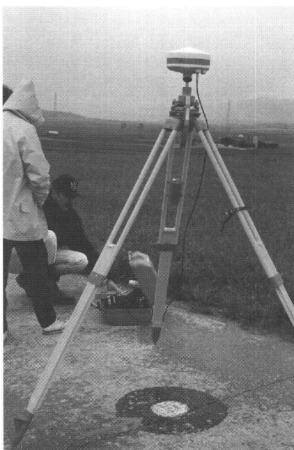
Fig. 3: Stationnement GPS sur l'un des repères. La matérialisation est assurée par une cheville PP scellée dans le chemin en béton, avec sa signalisation photogrammétrique.
