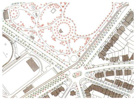
Abb. 3: Baumkataster auf der Grundlage der amtlichen Vermessung.
