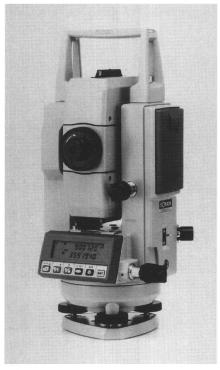
play angezeigt. Dieses kann auch beleuchtet werden. Mit nur 6 Tasten können Schräg- und Horizontaldistanz, Höhenunterschied, Horizontal- und Vertikalwinkel aufgerufen und auf dem grossen LCD-Display abgelesen werden
