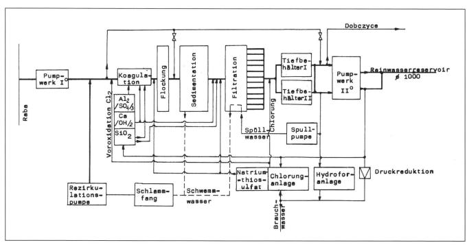
Abb. 5: Wasseraufbereitung im Wasserwerk Raba I.
