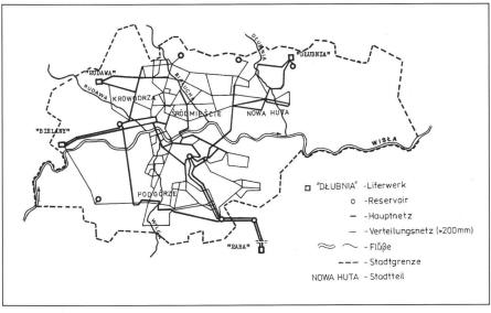
Abb. 2: Wasserversorgung der Stadt Kraków: Wasserwerke und Hauptleitungen. Fig. 2: Approvisionnement en eau de Kraków (Cracovie): usines et conduites principales.
