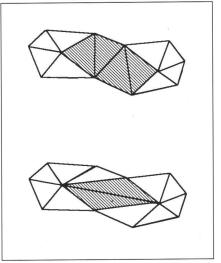
Abb. 3: Iterative Dreiecksumbildung: a) Dreieckskonfiguration vor der Umbildung, b) Dreieckskonfiguration nach der Umbildung.
