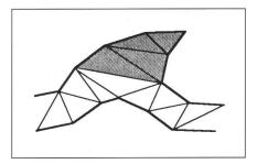
Abb. 4: Durch Plateaubildung (grau) eingeschränkter Interpolationsbereich.
