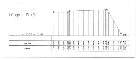
Abb. 8: Profilberechnung zwischen den Punkten A und B.
