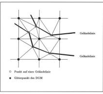
Abb. 1: Verdichtung der Gitternetzmaschen durch Dreiecksseiten.
