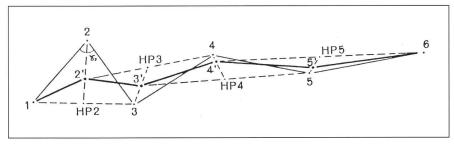
Abb. 6: Glättung eines Isolinienpolygons.
