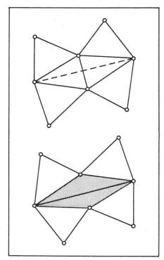
Abb. 2: Grundprinzip der Dreiecksumbildung: a) fehlende Sollseite, b) hergestellte Sollseite.
