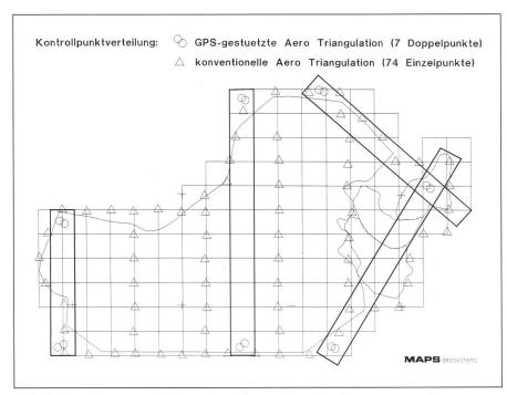
Abb. 1: Flugplanung und Kontrollpunktverteilung der Aerotriangulation.
