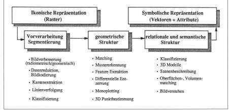
Abb. 2: Bildtransformation (automatisches Verfahren); Verarbeitungsstufen und zugeordnete Algorithmen.
