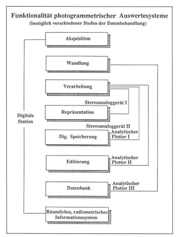
Abb. 5: Funktionalität verschiedener Systeme der Photogrammetrie.
