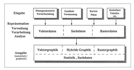
Abb. 1: Komponenten moderner Geo-Informationssysteme.
