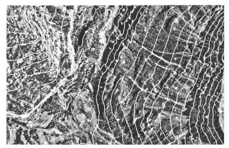
Abb. 8: Digitales Orthophoto mit integrierten Höhenlinien (Gebiet Simplon).
