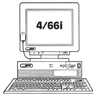
**COMPAQ DESKPRO 4/66i.** Die Rennmaschine für das mittlere Budget. Modell 120w, 486DX2/66 MHz Prozessor, 4 MB RAM, 120 MB Harddisk, QVision Grafikkarte, Business Audio, Mikrofon, DOS 5.0, Windows 3.1, Maus.
