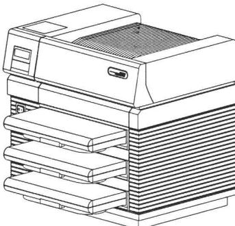
**COMPAQ PAGEMARQ 20.** Das Laserdrucksystem von morgen. PostScript Level 2, PCL 5, Format A3/A4, Auflösung 800 x 400 dpi, automatische Protokollanpassung, Parallel/ Seriell Netzwerk direkt, 20 Seiten pro Minute.
