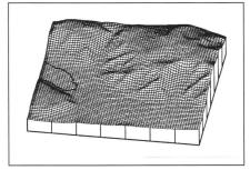
Abb.3: DHM25-Matrixmodell aus Abb. 2 mit 59 x 59 = 3481 Matrixpunkten in einer regelmässigen Anordnung mit 25 m Maschenweite. Perspektivische Darstellung aus Richtung SSE.
