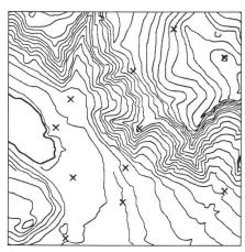
Abb. 2: DHM25-Basismodell aus Abb. 1 mit insgesamt 2123 Punkten auf Höhenkurven, 37 Punkten auf Seekonturen und 11 Einzelkoten in unregelmässiger Verteilung.
