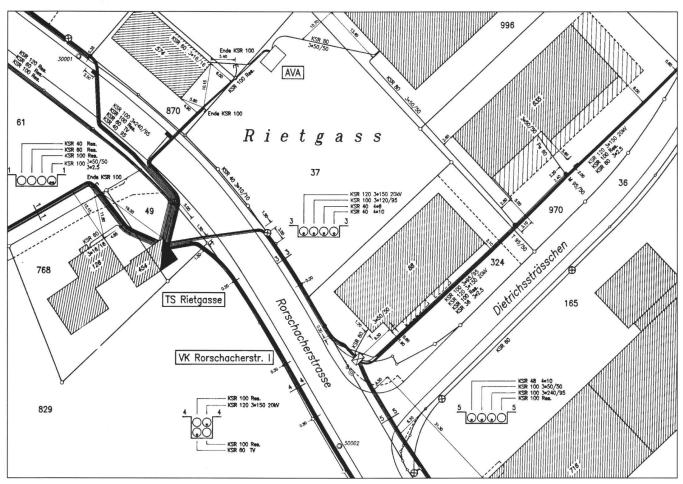
Abb. 2: Werkplan Elektrizität: Kabelplan.
