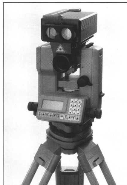
WILD DIOR3002S in Kombination mit einem WILD T1010/1610 – die ideale Messausrüstung für jede Distanzmessaufgabe.
