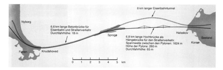
gende kleine Insel Sprogø. Die Anlage wird sich aus folgenden Bauwerken zusammensetzen:
