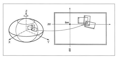
Fig. 2: Les coordonnées géocentriques mesurées dans chaque session sont transformées en coordonnées planimétriques locales.
