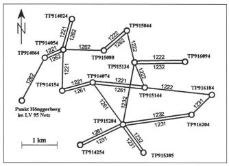
Abb. 3: Messungen im Triangulationsnetz mit Stations- und Sessionsnummer.
