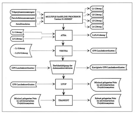
Abb. 5: Flussdiagramm der Auswertung.
