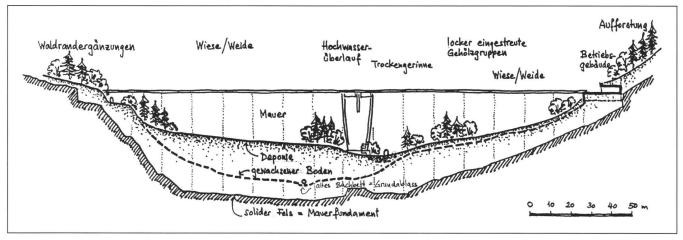
Abb. 3: Maueransicht und Geländeschnitt am Mauerfuss.
