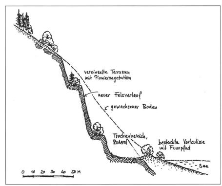
Abb. 5: Schnitt durch Steinbruch.
