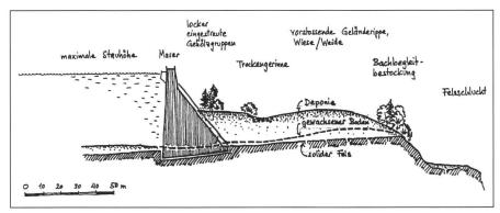
Abb. 4: Schnitt durch Mauer und Deponie in Talrichtung.
