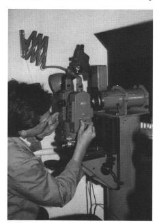
der Firma Kern in Aarau. Eine Antwort darauf gab die Firma Geometra AG in Oberentfelden. Sie hat Werkstattpersonal und Werkstatteinrichtungen von Kern übernommen, dazu weitere elektronische Testgeräte erworben, um sämtliche Kern-Nivelliere, Theodolite und elektronische Messausrüstungen fachgerecht und rasch zu reparieren. Eine Messstrecke für die Kalibrierung der elektronischen Distanzmesser ist ebenfalls vorhanden. Es versteht sich von selbst, dass Geometra auch andere Marken repariert.
