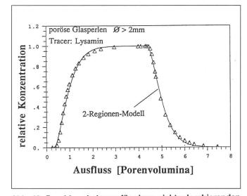
Abb. 10: Durchbruchskurve für einen nicht adsorbierenden Tracer in einem Säulenversuch mit porösen Glasperlen. Für die Modellrechnung wurden verschiedene Parameter unabhängig bestimmt. Der Transferkoeffizient ω wurde optimiert.
