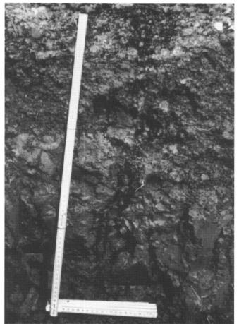
Abb. 4: Infiltrationsmuster eines im Wasser gelösten Farbstoffes in einem tonigen Boden. Das Wasser wurde mit einem Tensionsinfiltrometer unter Unterdruckbedingungen an der Bodenoberfläche infiltriert. Deutlich ersichtlich ist das ungleichförmige Muster der Wasserbewegung.
