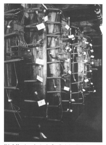
Abb. 3: Messtunnel unter der Gemüsekultur. Die Instrumente zum Absaugen von Bodenlösung wurden seitlich von der Tunnelwand aus 1 m tief in den Boden eingebaut.
