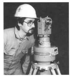
Vermessungskreisel ermöglichen genaue Richtungsbestimmungen unabhängig vom Magnetfeld der Erde.
