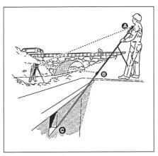
Das Problem ist allen Vermessungsfachleuten bekannt: Aufzunehmende Punkte in Leitungsgräben, oft noch zusätzlich durch Deponien verdeckt, in Schächten, schwer zugängliche Gebäudepunkte usw. Diese lassen sich meistens nur durch aufwendige Stationierung und über mehrere Hilfspunkte einmessen.
