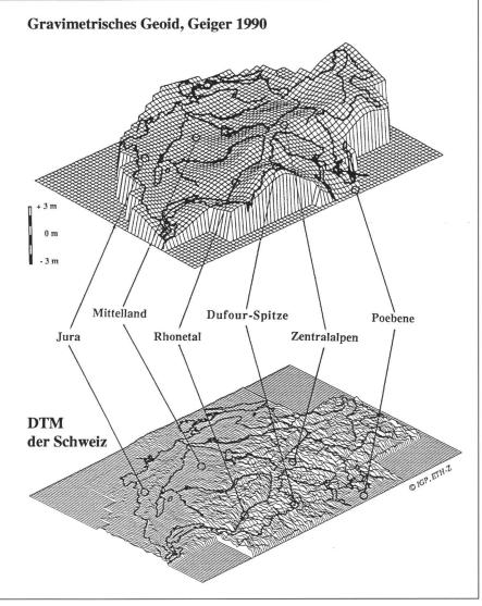
Das gravimetrische Geoid der Schweiz (Geiger, 1990) lässt erkennen, wie die Oberfläche eines helvetischen Ozeans aussähe, wenn die Weltmeere durch Kanäle miteinander verbunden wären (Perspektive von SW nach NO). Deutlich erkennbar ist die Anhebung des Geoids im Alpenbereich und die Absenkung in den grossen Tälern, im Mittelland und in der Poebene.
