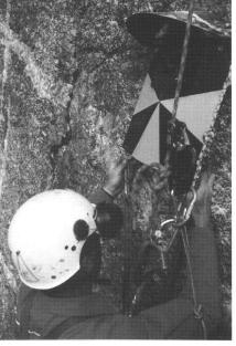
Abb. 2: Montage einer Zieltafel mit Reflektor in der Felswand.
